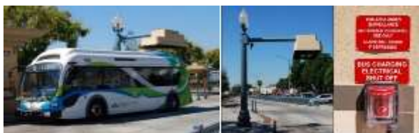
Hình 11. Mô hình sạc theo dọc theo tuyến đường và có chức năng ngắt điện khẩn cấp
