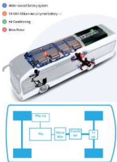
Hình 9. Các bộ phận chính của xe bus điện dùng pin (BEB)
