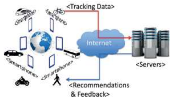
Hình 2. Sơ đồ thu thập, lưu trữ, xử lý và phân tích dữ liệu liên quan đến sự di chuyển bằng cảm biến điện thoại thông minh
