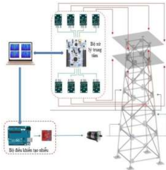
Hình 2. Sơ đồ đấu nối phần cứng mô hình OJP với bộ điều khiển trung tâm.
