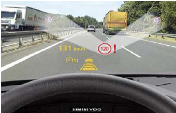
Hình 8. Phát hiện biển báo đường cho ứng dụng cảnh báo tốc độ
