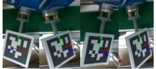
Hình 5. Sử dụng chương trình VISP để ước lượng và thu được vị trí và góc hướng của bảng “April Tag”.
