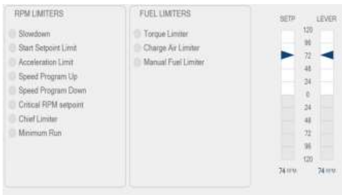
Hình 6. Menu điều chỉnh các giới hạn của động cơ [2]
