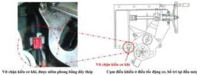
Hình 2. Niêm phong vít chặn giới hạn kiểu cơ khí
