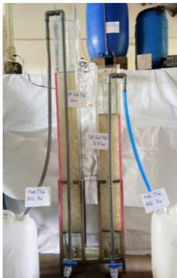
Hình 2. Mô hình thực tế vận hành bể lọc sinh học hiếu khí ngập nước
