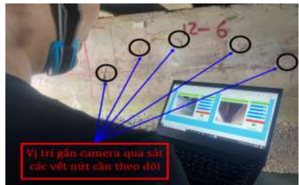
Hình 3. Thực nghiệm quan sát nhiều vị trí vết nứt
