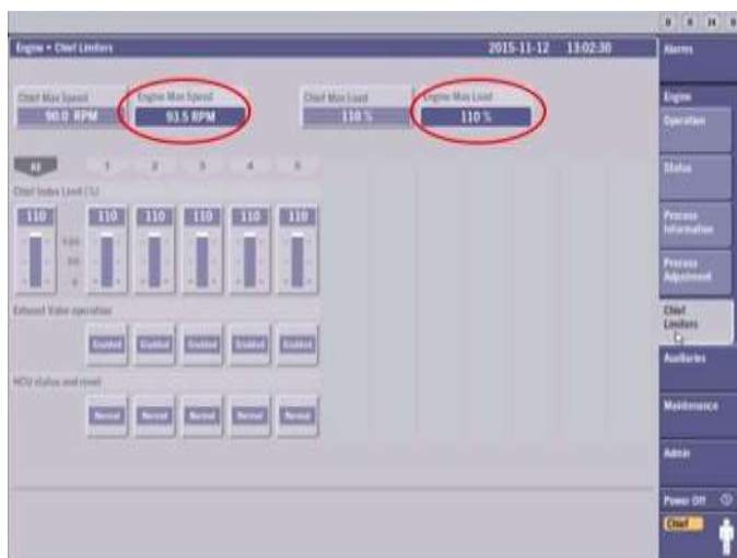
Hình 7. Phần mềm CoCos - EDS điều chỉnh giới hạn công suất động cơ [2]
