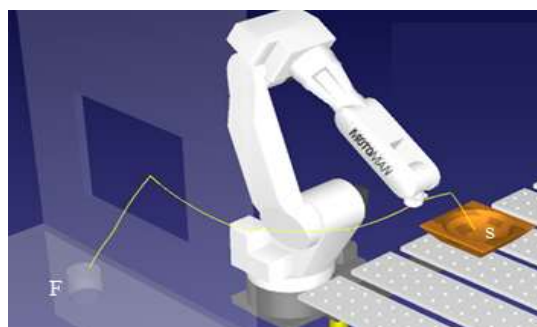
Hình 1. Robot UP-6 sáu bậc tự do được đặt trong môi trường có vật cản biết trước.
